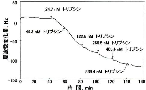
Fig. 8 BBI固定化QCMセンサーの周波数変化
