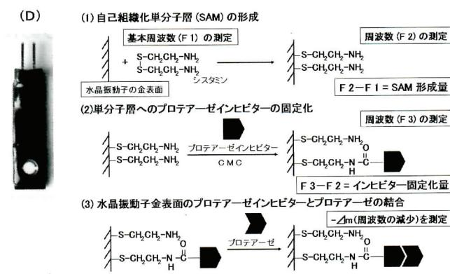
Fig. 2 QCM法による分子間相互作用の解析原理
